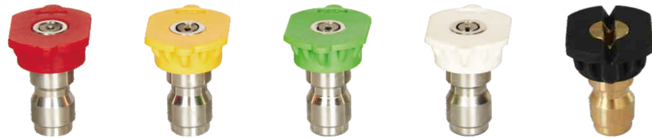
红: 0度 (直线) 黄: 15度 (扇形) 绿: 25度 (扇形) 白: 40度 (扇形) 黑: 泡沫喷头
